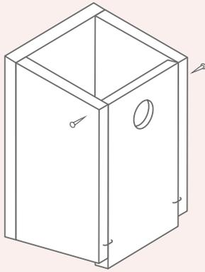
**Paso 3:** Coloca y fija la parte delantera entre las paredes laterales. Para que puedas abrir la parte delantera para limpiar la casita, sujeta la pieza solamente con dos clavos en la parte superior, uno a la izquierda y otro a la derecha. Para evitar que los pájaros empujen accidentalmente la parte delantera para abrirla, pon un gancho en el borde de las paredes laterales a izquierda y derecha.
