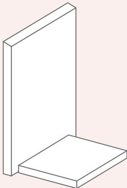
**Paso 1:** Atornilla la base al centro de la pared trasera, de modo que quede espacio para las dos paredes laterales a izquierda y derecha.
